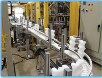
MOLDEO POR SOPLADO CON ESTRUSION CONTINUA
